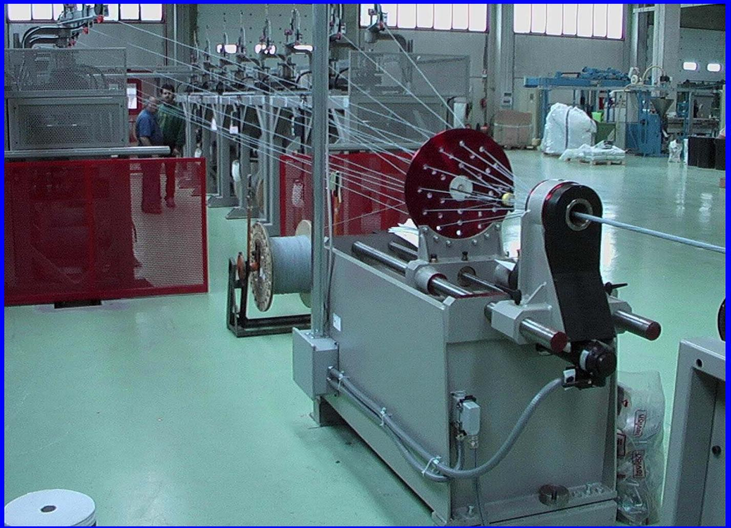
ЛИНИЯ ОДНОНАПРАВЛЕННОЙ СКРУТКИ ДЛЯ СПЕЦИАЛЬНЫХ КАБЕЛЕЙ, МИКРОКОАКСИАЛЬНЫХ, МУЛЬТИ-L.A.N. И ОПТОВОЛОКОННЫХ КАБЕЛЕЙ.
